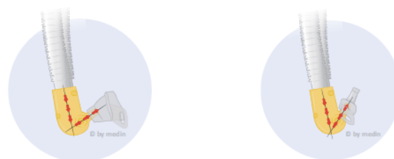
Obrázek 8 - Nastavení úhlu přístroje Miniflow
