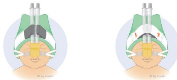
Figura 9 - Fissaggio del Miniflow alla cuffia
